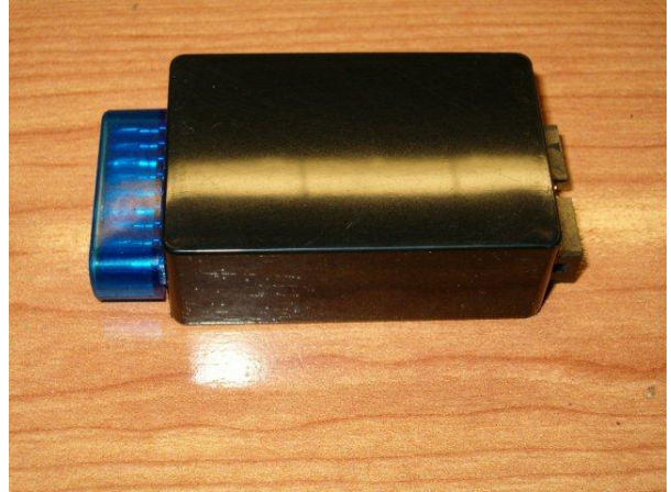
Adaptador 1 puerto con caja plástico 76x50mm
