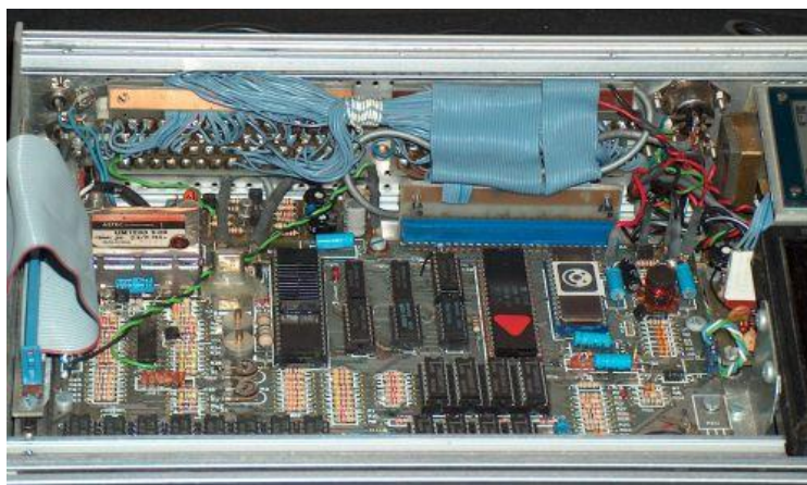
Detalle de la placa interna con sus nuevas conexiones bien visibles
