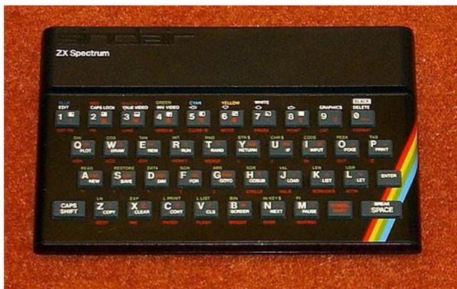
El inconfundible "gomos". Salíó en sus versiones de 16k y 48k. De este último hubo varias versiones con escasas modificaciones en su circuitería, como el cambio del disipador de calor y variaciones en los puertos del teclado (issues 1, 2, 2A y 3).
